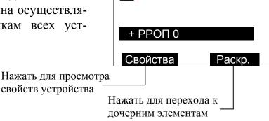
Для просмотра или изменения свойств устройства нажать на экранную клавишу **Свойства** >.
